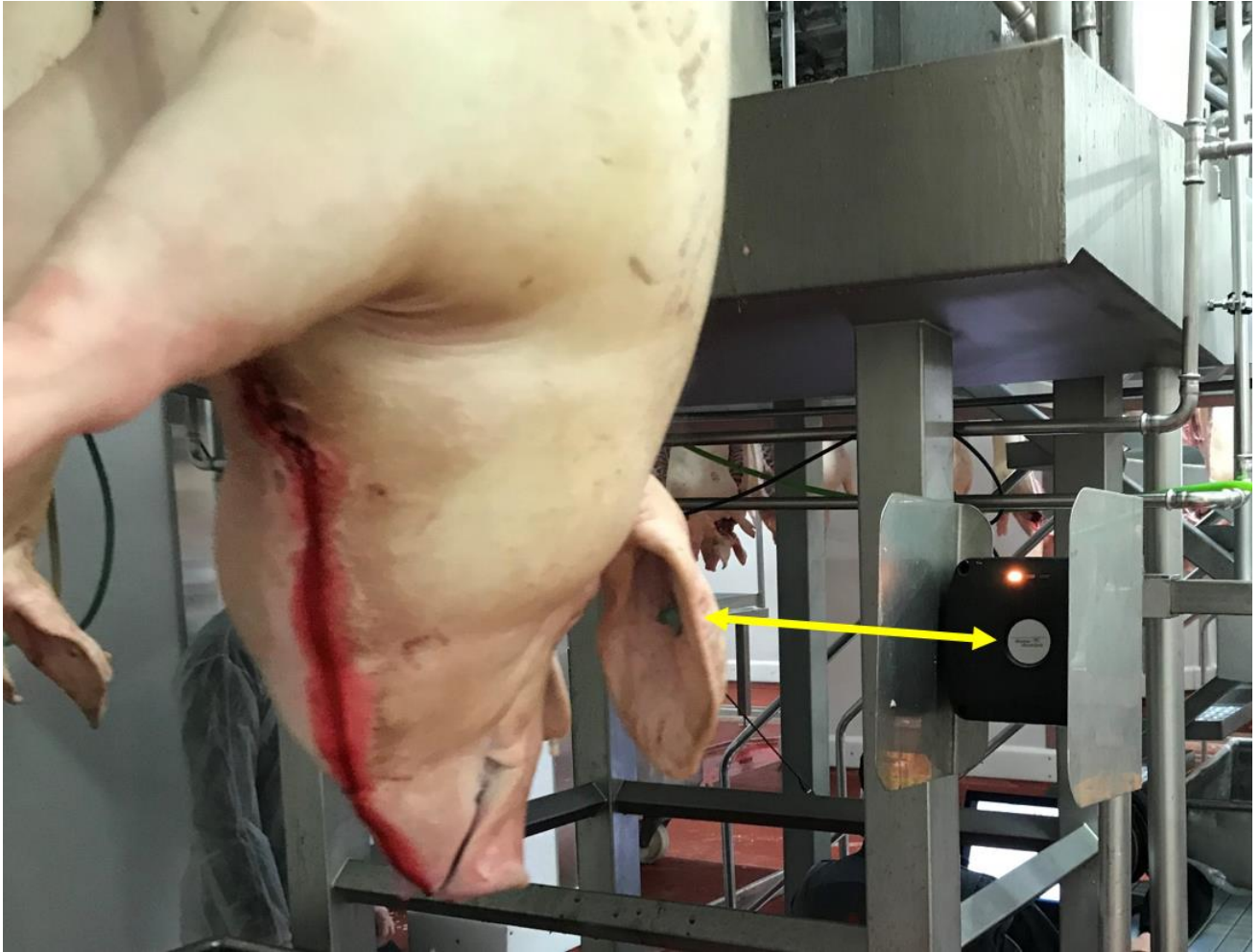
Abbildung 13: UHF-RFID-Lesestation im Schlachthof Crailsheim (Bildquelle: © VION Crailsheim)
